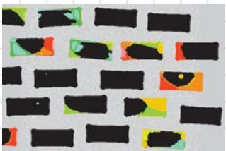
电子元件、陶瓷零件 电容器、传感器等的层间脱层、裂纹 (芯片电容器各深度的层间剥离)
