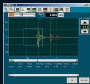
能计测距离、时间和强度，并能进行波形的重叠显示等波形分析。
